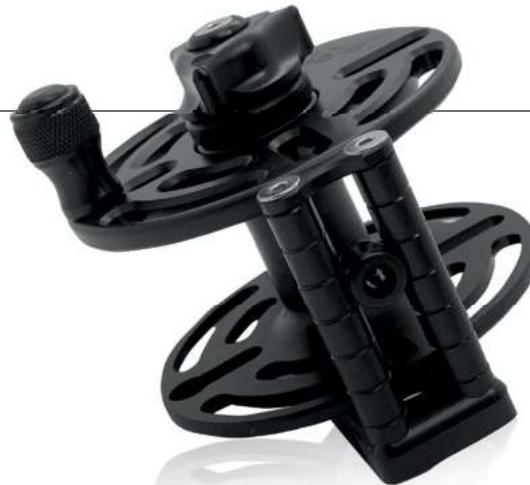
Fabricados en Delrin. Alta resistencia y mínimo Peso. 92 gr (versión 30 mt.) Bobinas guía-línea y de seguridad. Manilla antideslizamiento de fácil accionamiento. Freno por rodamientos. Mecanizado por CNC. Disponible en tres versiones: 30 – 55 – 95 mt.
